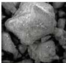
Particules à la géométrie adoucie (x1000)
